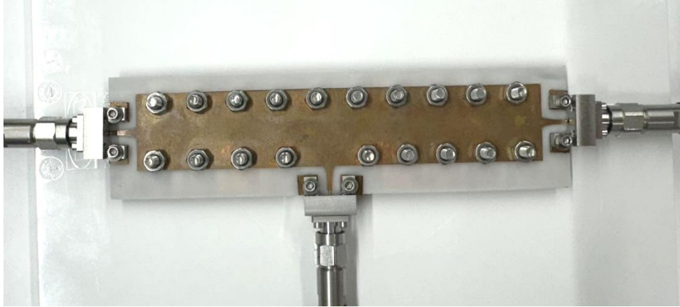
รูปที่ 12.2 วงจรกรรกรองแถบผ่าน CRD เมื่อทำการประกอบเสร็จแล้ว
