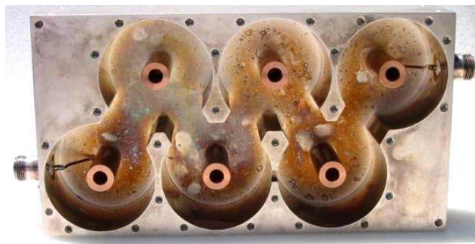
รูปที่ 7.1 วงจรรองแบบคอมป์ไลน์
