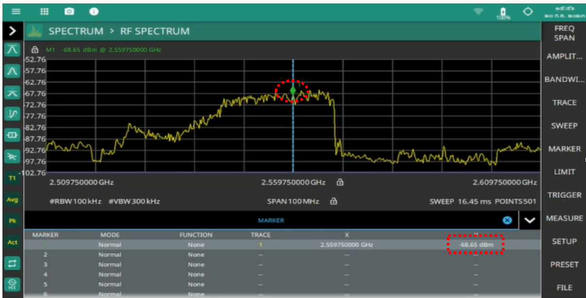
รูปที่ 12ก แสดงค่าความแรงคลื่นแม่เหล็กไฟฟ้า กรณีติดตั้งเครื่องมือวัดอยู่ในทิศทางที่ลำคลื่นส่งสัญญาณมายังลูกข่าย
