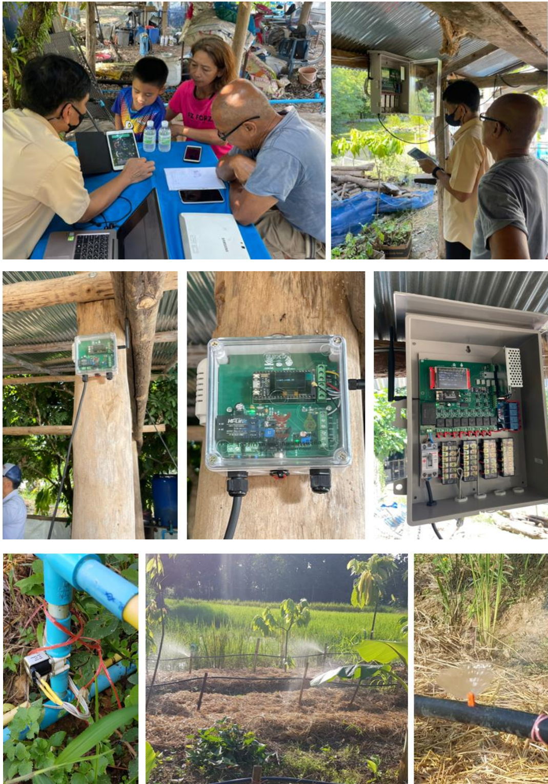
รูปที่ ๔.๑๖ การใช้งานระบบการให้น้ำด้วย IoT Controller Module และ Sensor Node ในแปลงปลูก Cocoa แบบหลายแปลง
