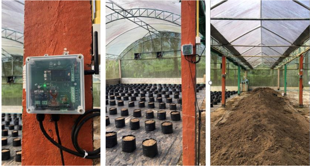
รูปที่ ๔.๑๐ การติดตั้งและใช้งาน Microclimate Sensor Node ในโรงเรือน สื่อสารด้วย LoRa Technology
