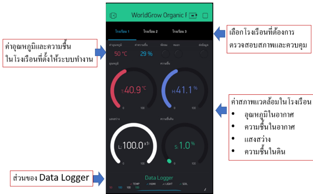
รูปที่ ๔.๑๒ ส่วนประกอบและค่าจาก Microclimate Sensor ต่างๆบนหน้าจอของ Mobile Application
