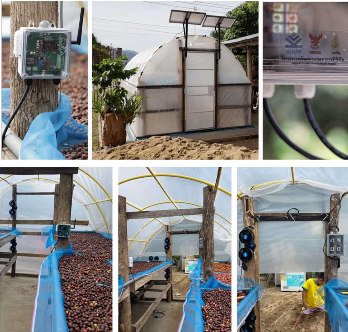
รูปที่ ๔.๑๗ การประยุกต์ใช้อุปกรณ์ในโครงการกับโรงอบแห้งพลาสติกพลังงานแสงอาทิตย์ สำหรับอบกาแฟและโกโก้
