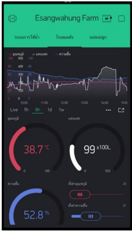
รูปที่ ๔.๑๙ เมนูการใช้งาน Mobile Application สำหรับระบบการให้น้ำ ระบบตรวจสอบสภาพแปลงปลูก และระบบควบคุมภายในโรงอบแห้งพลังงานแสงอาทิตย์
