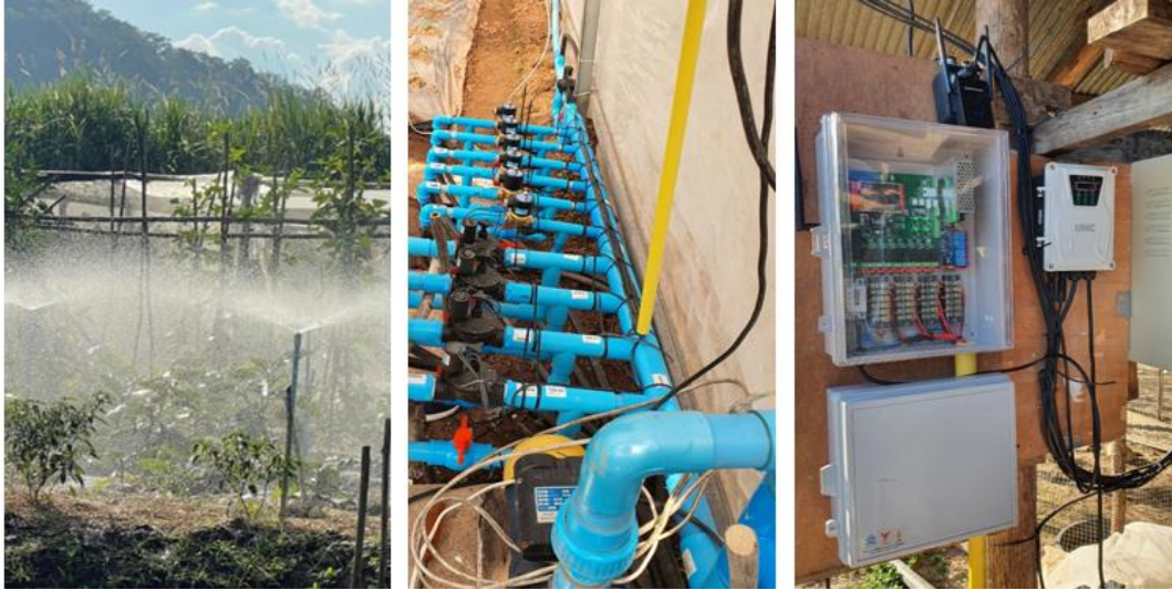
รูปที่ ๕.๒ อุปกรณ์อิเล็กทรอนิกส์สำหรับควบคุมระบบน้ำในฟาร์มด้วย Mobile Application
