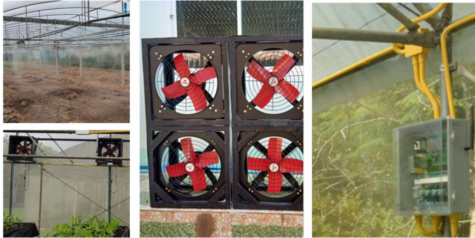
รูปที่ ๕.๔ ระบบระบายความร้อนในโรงเรือนด้วยพัดลมและระบบพ่นหมอกด้วยเทคโนโลยี IoT
