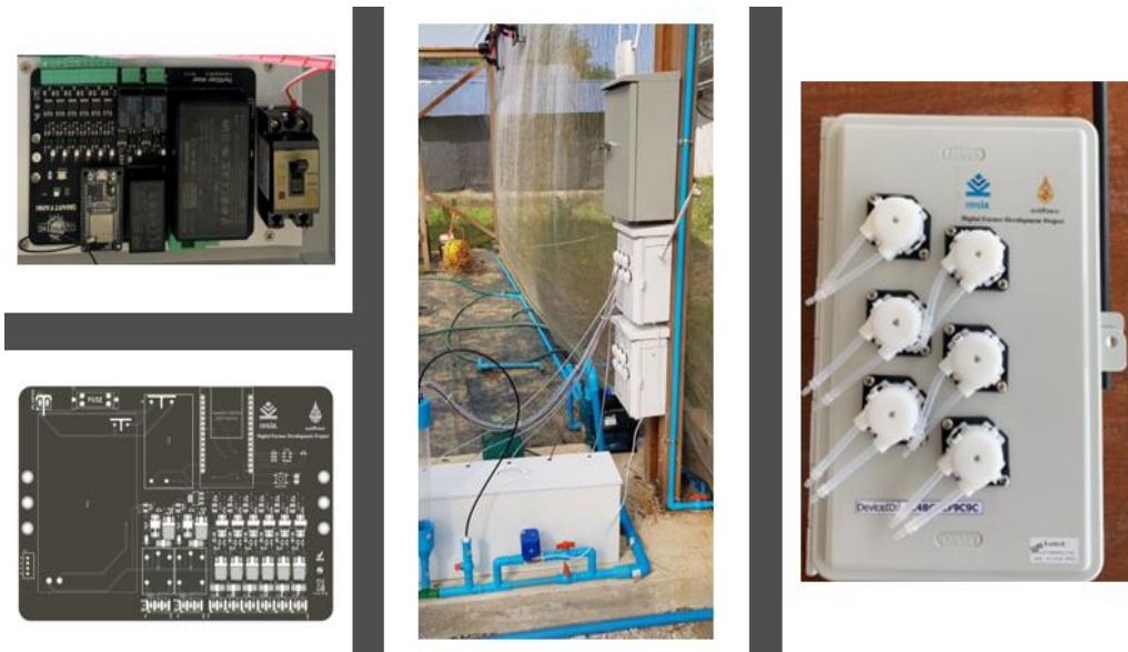
รูปที่ ๕.๓ อุปกรณ์อิเล็กทรอนิกส์และระบบการให้ปุ๋ยน้ำทางท่อ
