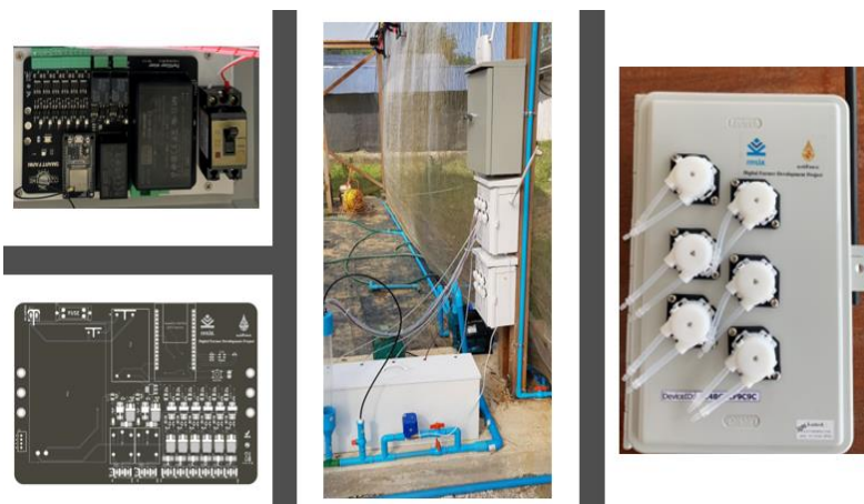
รูปที่ ๔ อุปกรณ์อิเล็กทรอนิกส์และระบบการให้ปุ๋ยน้ำทางท่อ
