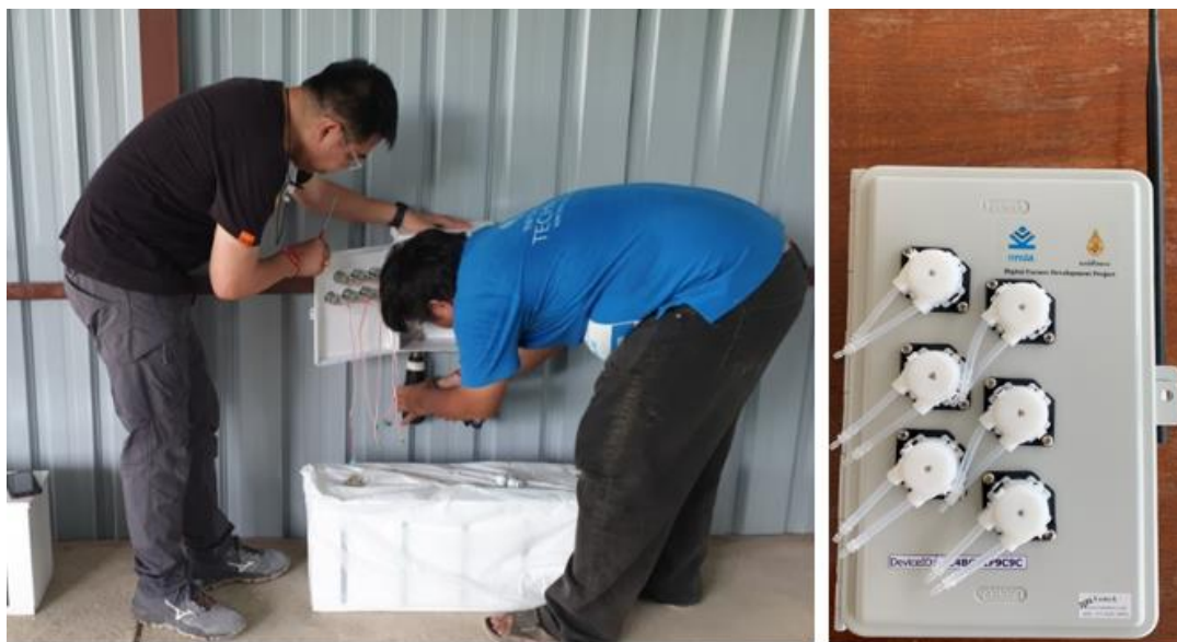
รูปที่ ๓.๑๑ การทดสอบต้นแบบระบบการผสมปุ๋ยและให้ปุ๋ยอัตโนมัติทางท่อ
