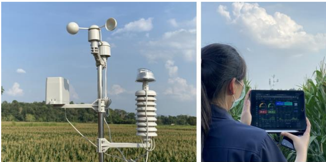
รูปที่ ๓.๑๓ เซนเซอร์บนสถานีตรวจวัดสภาพอากาศขนาดเล็กและการแสดงผล
