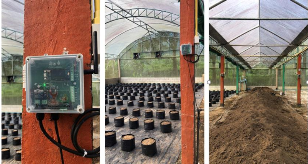
รูปที่ ๔.๑๐ การติดตั้งและใช้งาน Microclimate Sensor Node ในโรงเรือน สื่อสารด้วย LoRa Technology
