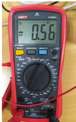
รูปที่ 4.16 กระแสขณะใช้งานเต็มที่ของสถานีอ้างอิง
