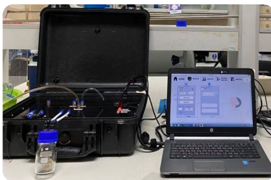
ภาพแสดงองค์ประกอบของเครื่องจมูกอิเล็กทรอนิกส์ (Electronic Nose)
