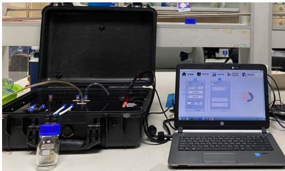
ภาพที่ 125 แสดงการจัดการทดลองวัดกลิ่นตัวอย่างด้วยเครื่องจุ่มกิโลเล็กทรอนิกส์
