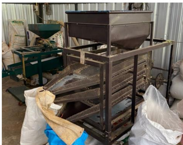
ภาพที่ 18 แสดงเครื่องคัดแยกขนาดเมล็ดกาแฟ
