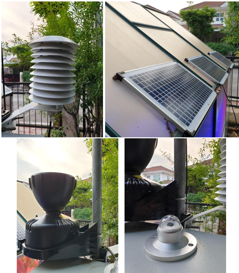
ภาพที่ 100 แสดงเซนเซอร์ชนิดต่าง ๆ ที่ติดตั้งบนสถานีตรวจวัดสภาพแวดล้อม
