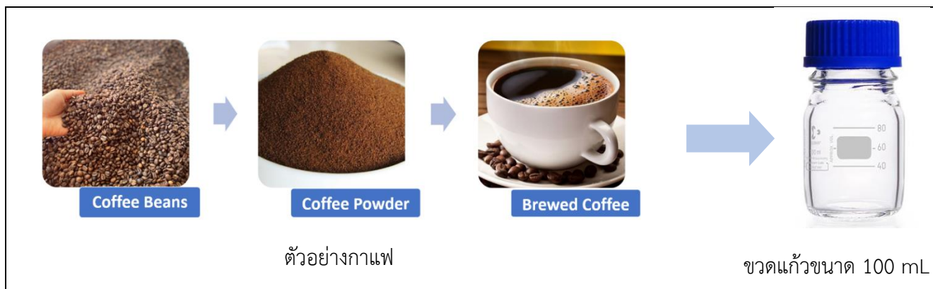
ภาพที่ 156 แสดงการเตรียมตัวอย่างกาแฟเพื่อทำการทดสอบกลิ่นด้วยเครื่องจมูกอิเล็กทรอนิกส์
