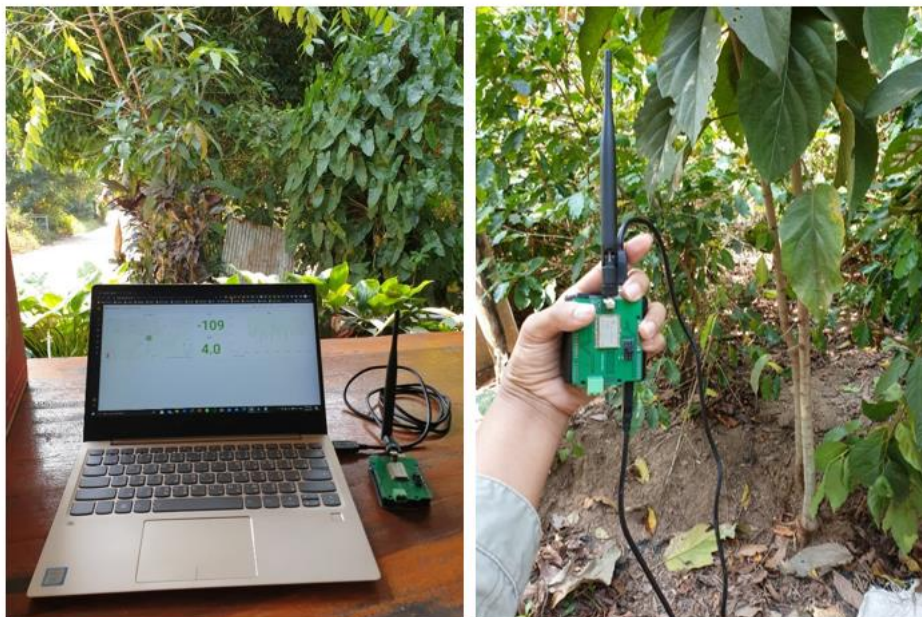
ภาพที่ 71 แสดงการทดสอบสัญญาณ LoRaWAN ภาคสนาม
