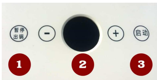
ภาพที่ 152 แสดงหน้าจอและปุ่มการทำงานของเครื่องคั่วกาแฟ (Lasantec)
