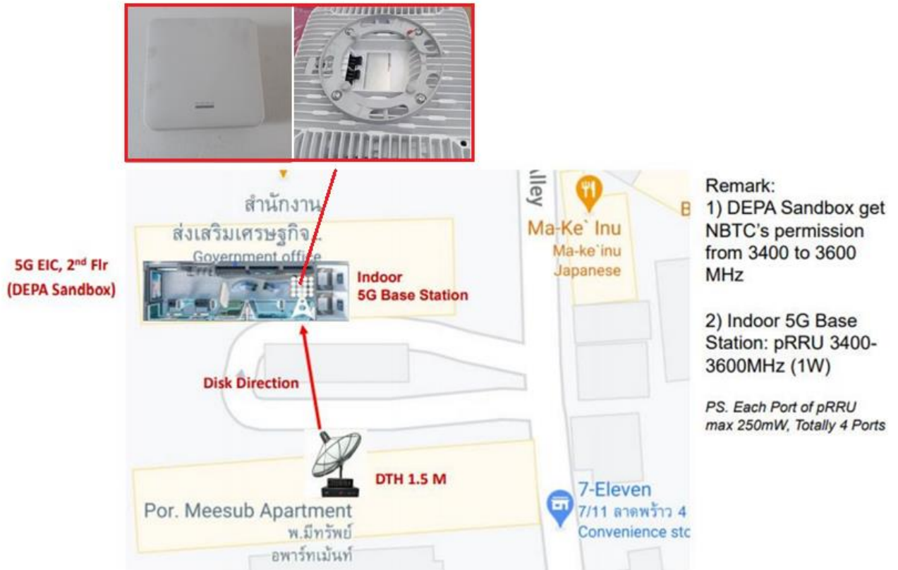
รูป 31 ตำแหน่งของสถานีฐาน 5G และจานดาวเทียมสำหรับการทดสอบกรณี Indoor ที่สำนักงานส่งเสริมเศรษฐกิจดิจิทัล
