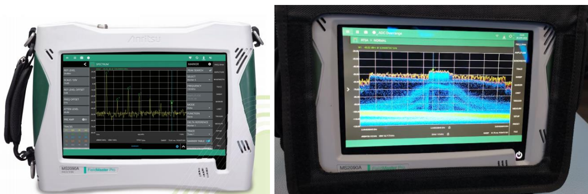
รูป 29 เครื่องวิเคราะห์สเปกตรัมสัญญาณ ตราอักษร Anritsu รุ่น Field Master Pro
