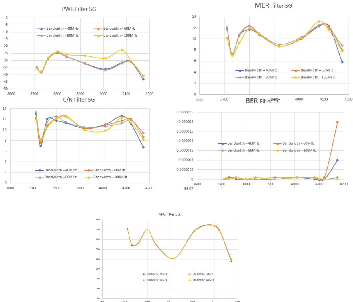
รูป 49 กราฟผลการทดสอบวัดค่าคุณภาพสัญญาณ LNB แบบมี Filter ตราอักษร B
