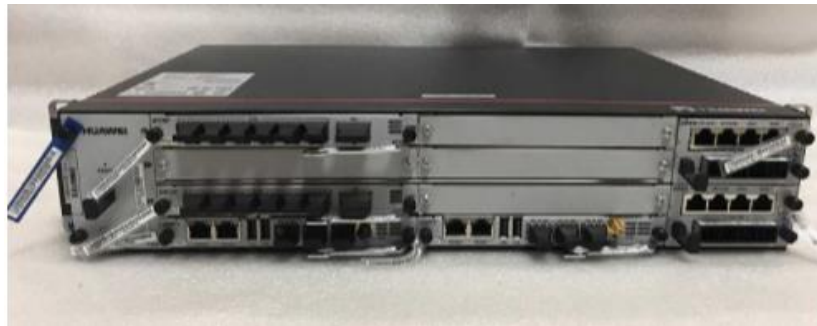
รูป 51 สถานีฐาน 5G ภายในอาคาร รุ่น 5G AAU5613 และ BBU5900 ของบริษัท Huawei
