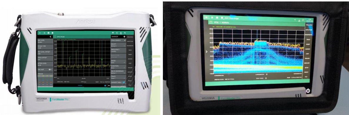
รูป 55 เครื่องวิเคราะห์สเปกตรัมสัญญาณ ตราอักษร Anritsu รุ่น Field Master Pro
