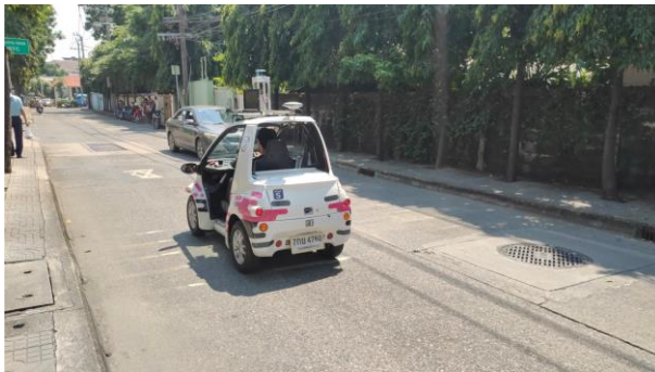
รูปที่ 1-31 รถที่ใช้เก็บข้อมูล เพื่อทำแผนที่ความละเอียดสูง ที่ภายใน สำนักงาน กสทช และ ซอยสายลม
