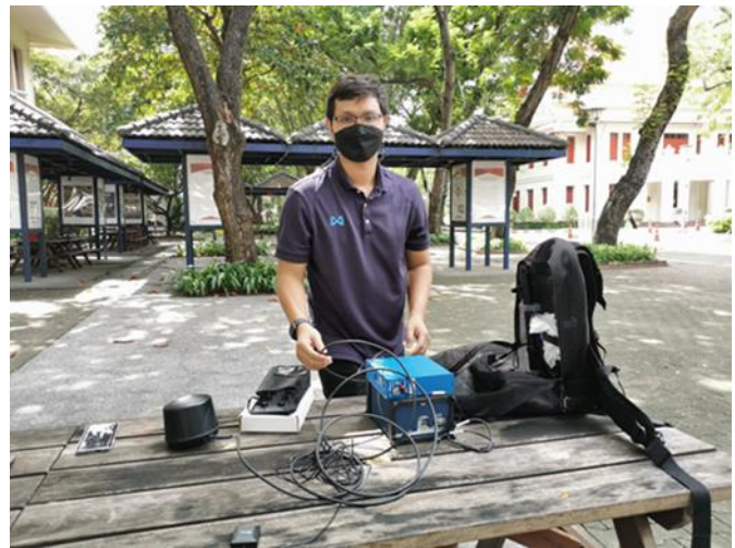
รูปที่ 3-5 อุปกรณ์เครื่องมือวัดทดสอบคุณภาพสัญญาณเครือข่ายระบบ 5G
