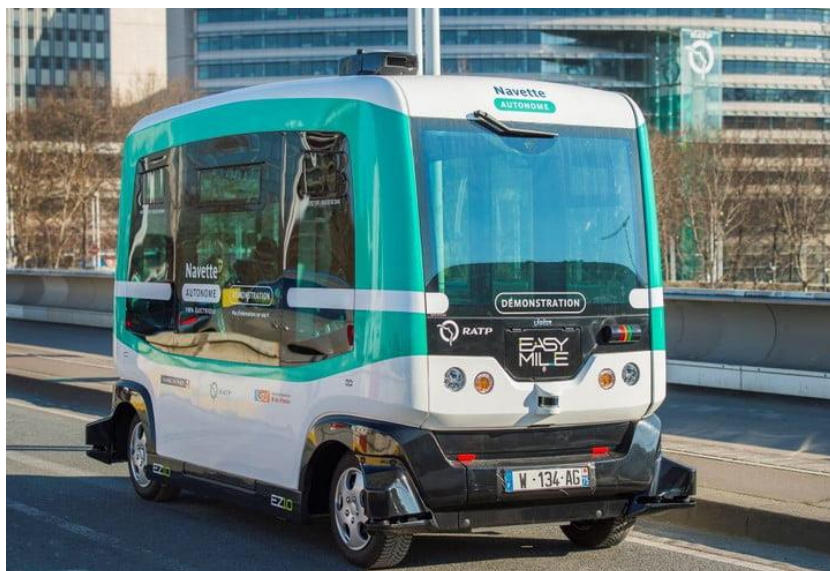
รูปที่ 2-12 Easy Mile (First-Last Mile Vehicle) ยานยนต์ขับเคลื่อนอัตโนมัติสำหรับขนส่งมวลชน (Trevor M., 2017)
