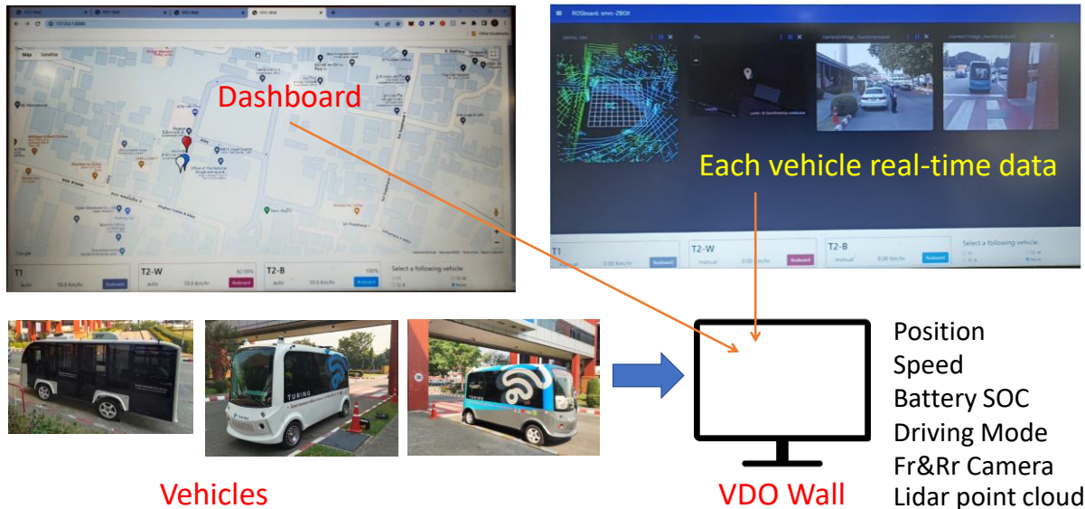
รูปที่ 1-42 แสดงระบบ Operation Dashboard ของรถอัตโนมัติ
