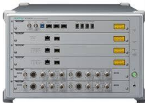
รูปที่ 3-12 เครื่องมือทดสอบและจำลองการรับส่งสัญญาณระบบ 5G (MT8000A)
