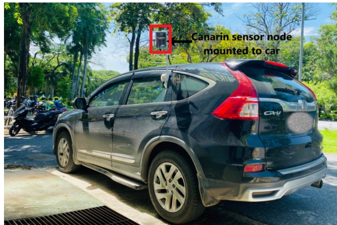
รูปที่ 45 อุปกรณ์ Canarin ที่ติดตั้งอยู่บนรถยนต์สำหรับการทดสอบ Mobility Drive Test
