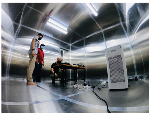
รูปที่ 53 การทดสอบเซ็นเซอร์ในห้องทดลองและปฏิบัติการแบบระบบปิด
