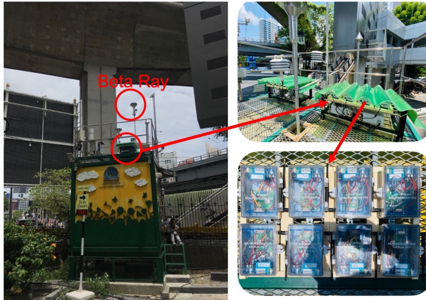
รูปที่ 58 การทดสอบ Canarin เซ็นเซอร์ กับเครื่องวัดมาตรฐานของกรมควบคุมมลพิษ บริเวณสถานี โรงพยาบาลจุฬาฯ
