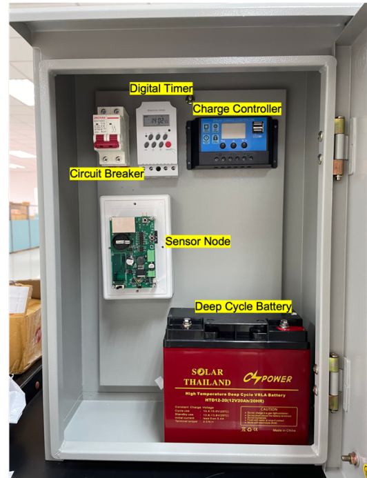
รูปที่ 68 ส่วนประกอบของชุดเซ็นเซอร์และระบบพลังงานแสงอาทิตย์
