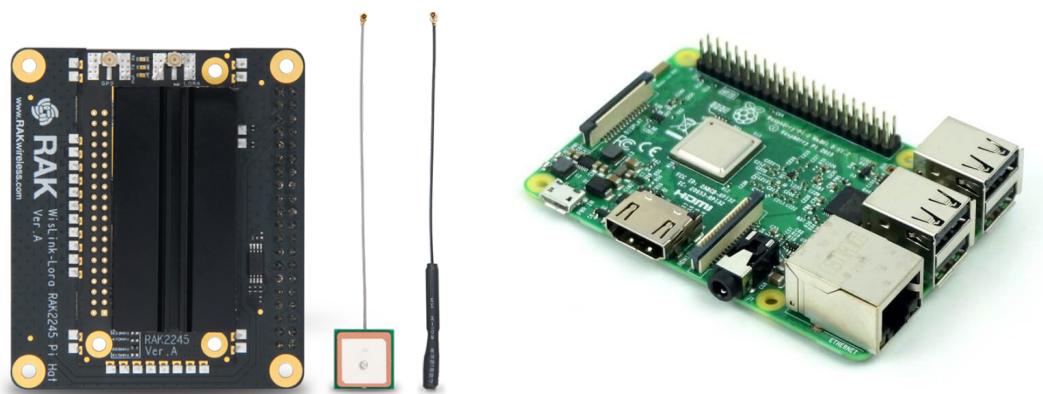
รูปที่ 31 LoRa โมดูล RAK 2245 สำหรับการ พัฒนา LoRa เกตเวย์
