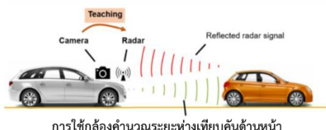
การใช้กล้องคำนวณระยะห่างเทียบคันด้านหน้า
