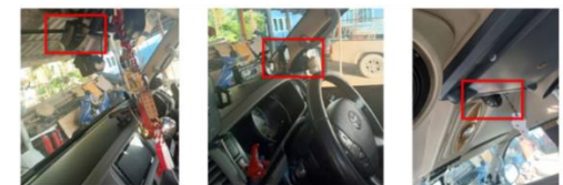
ตำแหน่งการติดตั้งอุปกรณ์รับภาพภายในรถ
