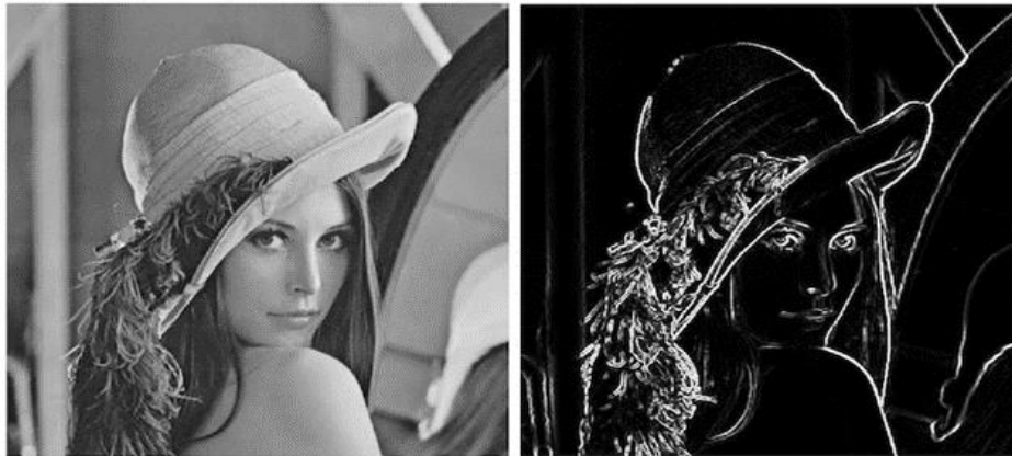
ภาพที่ 8-41 ตัวอย่าง feature map 67 ที่สร้างขึ้นในชั้น convolution layer
