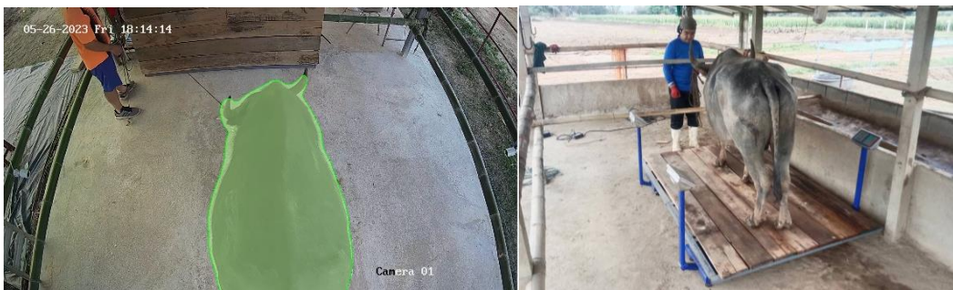
ภาพที่ 4-22 แสดงการนำข้อมูลรูปภาพที่แปลงเป็น (a) จำนวนพิกเซลมาเปรียบเทียบกับ (b) โหลดเซลล์
