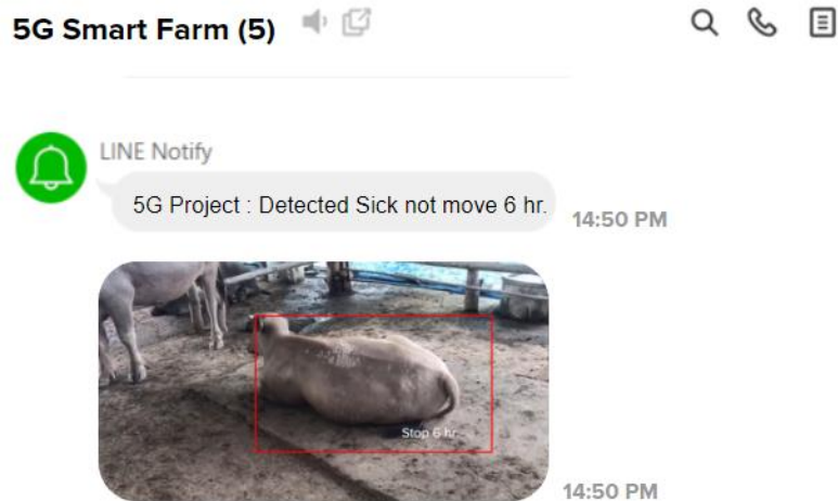
ภาพที่ 4-59 การแจ้งเตือนผ่านแอปพลิเคชัน “Line” เมื่อตรวจพบกระบือที่ไม่เคลื่อนที่เป็นเวลา 6 ชั่วโมง
