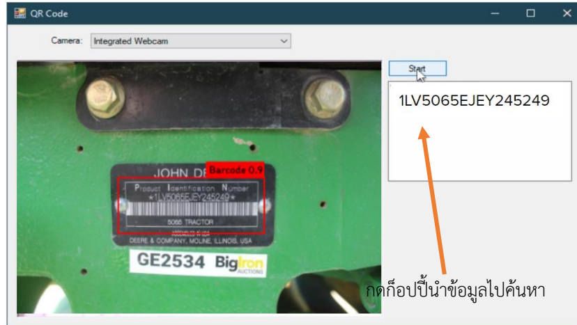
ภาพที่ 8-33 ภาพแสดงการทำงานของระบบอ่านพาร์ทอะไหล่
