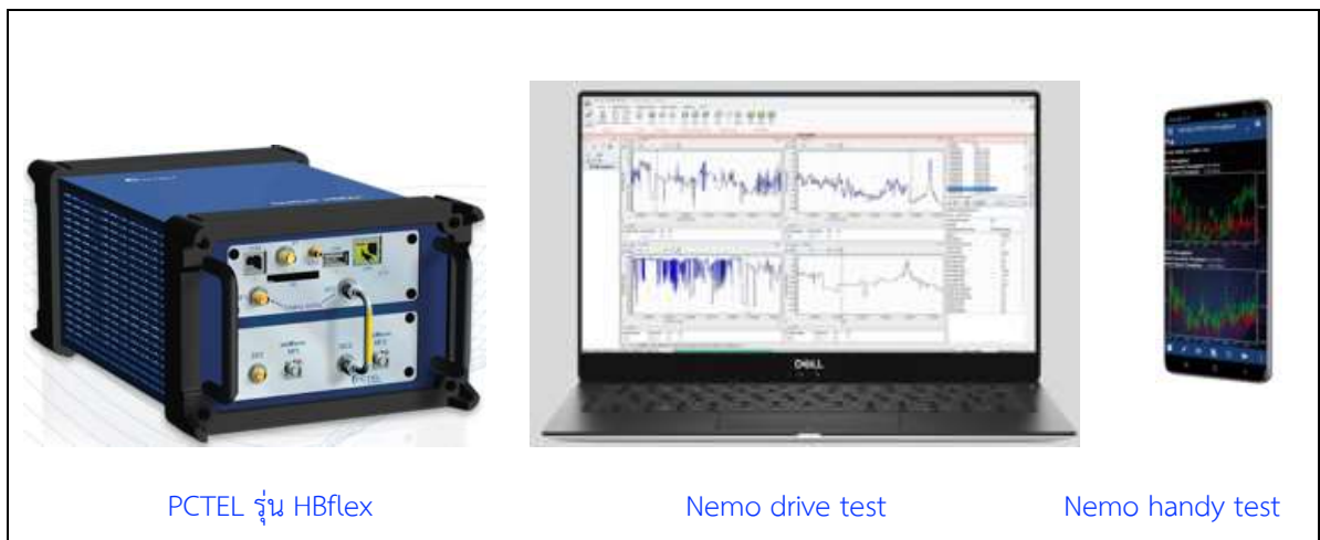
รูปที่ 19ก Nemo Outdoor Drive test system
