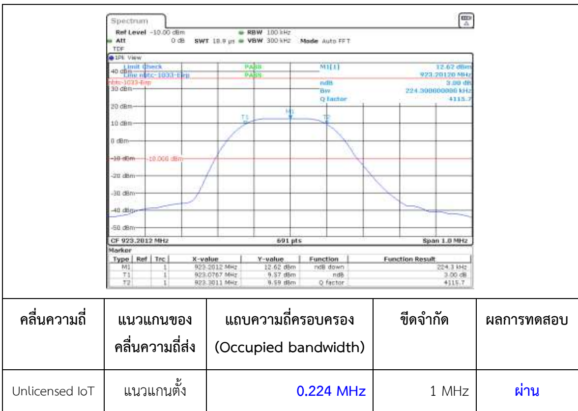
รูปที่ 22ก แสดงกราฟตัวอย่างผลการวัดค่าแถบความถี่ครอบครอง
