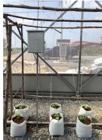
ภาพที่ 56 Wireless module วัดความชื้นดิน
