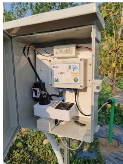
ภาพที่ 46 Wireless module วัดความชื้นดิน
