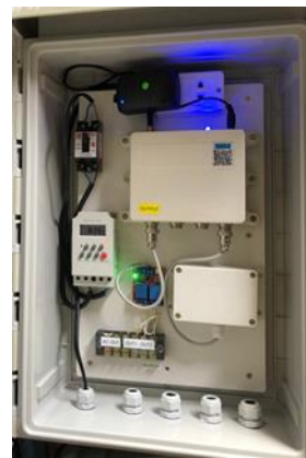
ภาพที่ 31 การติดตั้งอุปกรณ์อ่านค่า/ส่งข้อมูลสำหรับเชื่อมต่อเซ็นเซอร์
