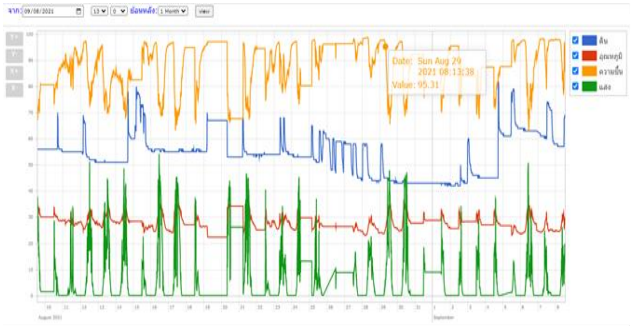
ภาพที่ 6 ค่าที่วัดได้จากเซนเซอร์วัดความชื้นดิน เซนเซอร์อุณหภูมิความชื้นอากาศ และเซนเซอร์วัดความเข้มแสง เป็นเวลา 1 เดือน
