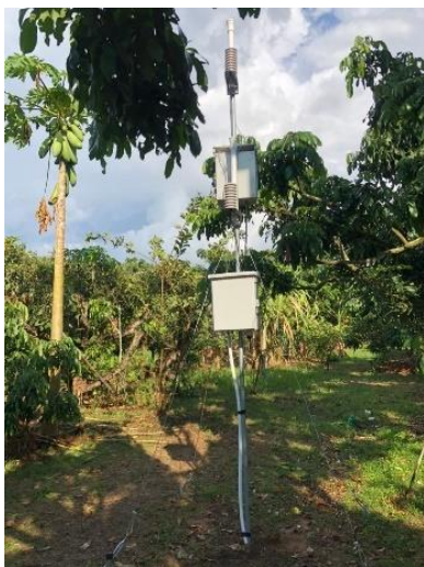
ภาพที่ 23 Wireless module วัดความเข้มแสง อุณหภูมิ ความชื้นอากาศ
