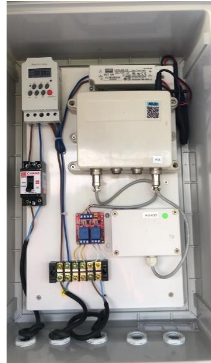
ภาพที่ 43 การติดตั้งอุปกรณ์อ่านค่า/ส่งข้อมูลสำหรับเชื่อมต่อเซ็นเซอร์
