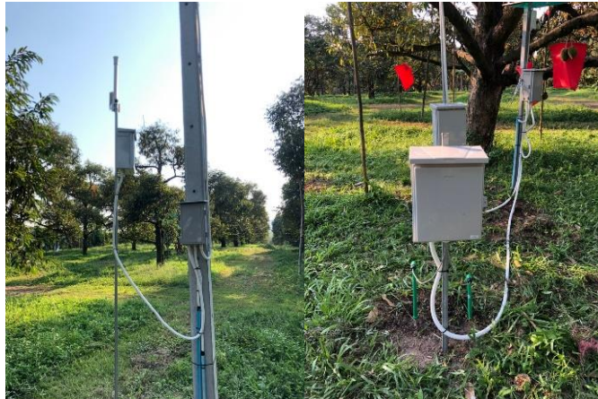
ภาพที่ 11 Wireless module วัดความเข้มแสง อุณหภูมิ ความชื้นอากาศ และความชื้นดิน
