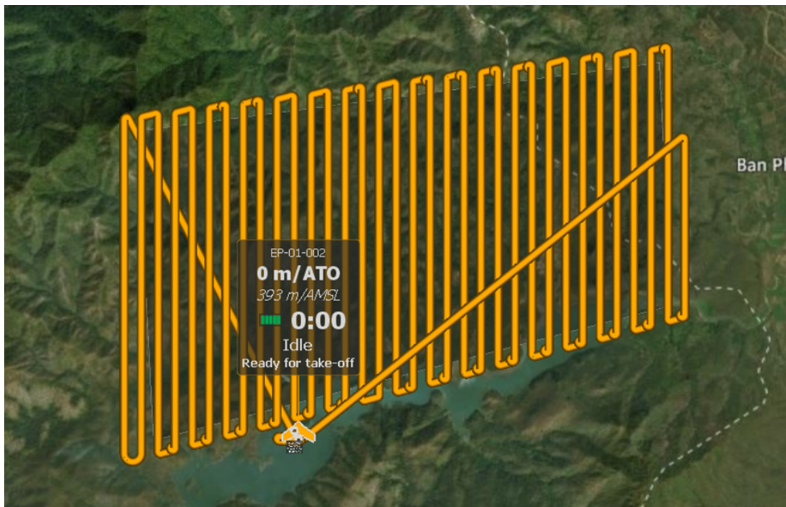
ภาพที่ 3-17 แสดงแนวการบินสำหรับพื้นที่การบินที่ 5 (Block 5) และ Home5 สำหรับขึ้นบิน
