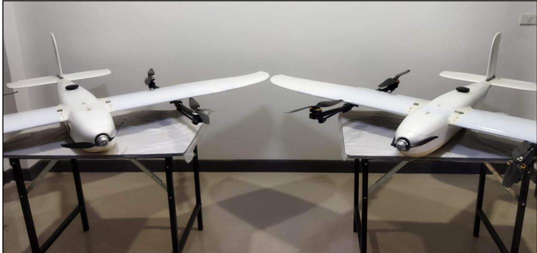
ภาพที่ 3-9 อากาศยานซึ่งไม่มีนักบิน (Drones) ที่ออกแบบสำหรับการบินตรวจการณ์ไฟฟ้าในพื้นที่
