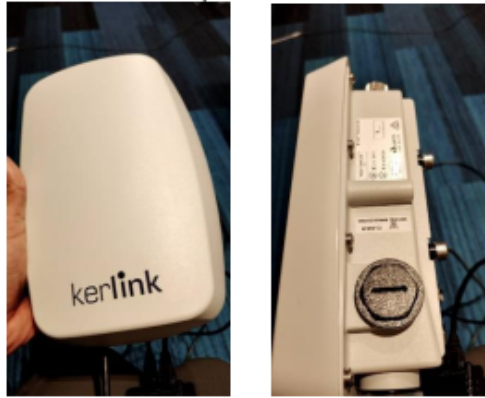
ภาพที่ 3-2 Gateway สำหรับเชื่อมต่อชุดเซ็นเซอร์ตรวจสอบสภาพแวดล้อมเข้ากับโครงข่ายสัญญาณ LoRaWAN
