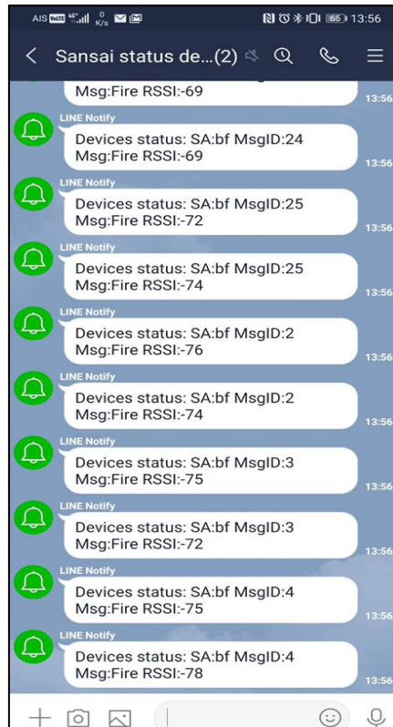
ภาพที่ 3-46 การแจ้งเตือนข้อมูลจากการติดตามการตรวจจับค่าฝุ่นและข้อมูลสภาพอากาศอื่น ๆ เพื่อ ติดตามไฟป่าในพื้นที่ผ่านระบบ Line Alert
