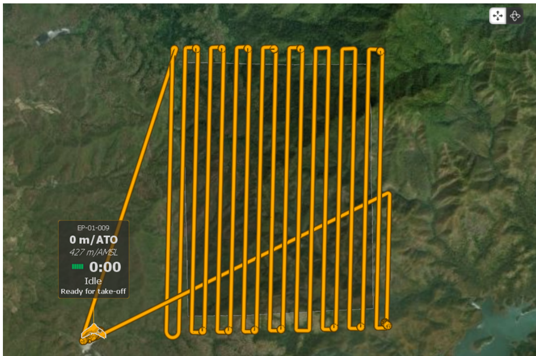
ภาพที่ 3-14 แสดงแนวการบินสำหรับพื้นที่การบินที่ 2 (Block 2)
