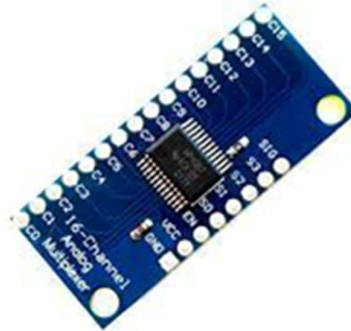
รูปที่ 2.33 บอร์ด Mux Breakout Cd74Hc4067
