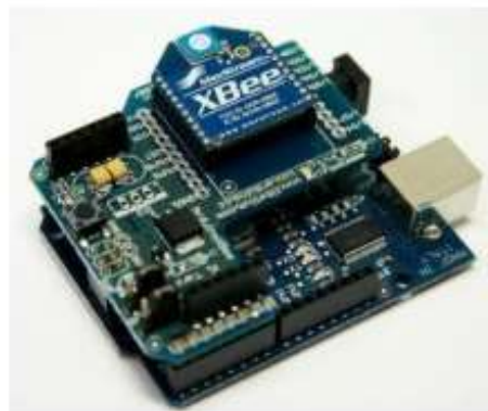
รูปที่ 2.24 การเชื่อมต่อบอร์ด Arduino กับ XBee Shield
