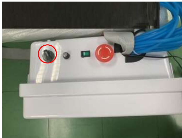
รูปที่ 8. ตัวปรับแรงดันลม หมุนตัวปรับแรงดันเพื่อปรับแรงดันลมจากน้อยไปมาก
