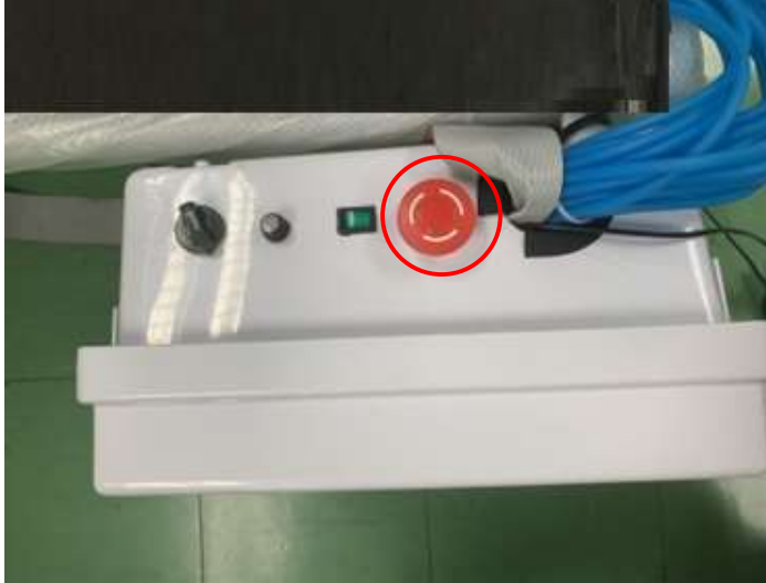
รูปที่ 5. สวิตช์ฉุกเฉิน กดเมื่อต้องการหยุดเครื่องฉุกเฉิน
