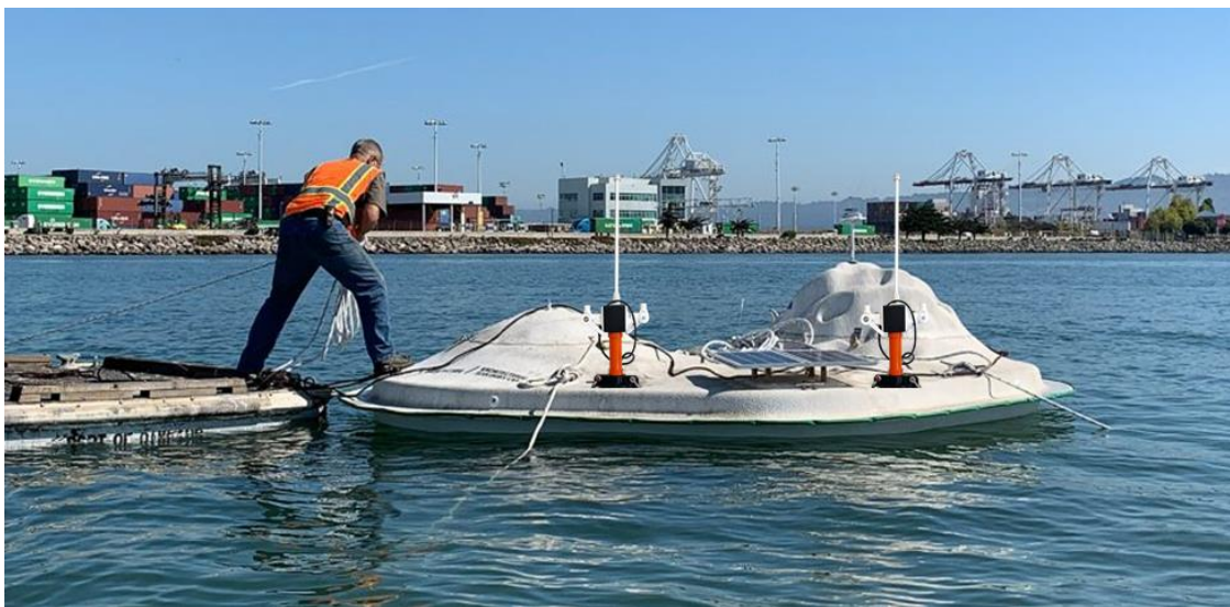
ภาพที่ 1.8 ตัวอย่างชุดระบบสื่อสารติดตั้งบนทุ่นลอยน้ำ
