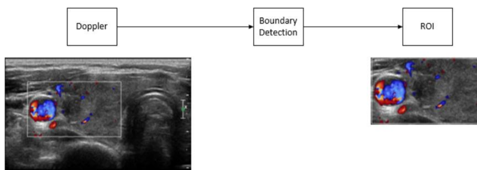
รูปที่ ๕๙ ภาพแสดงตัวอย่างการกำหนด Region of Interest ของภาพ Doppler
