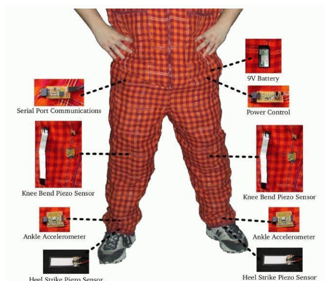
ภาพที่ 14 หลักการต้นแบบในการพัฒนาตรวจจับการเคลื่อนไหว เพื่อป้องกันการหกล้มในผู้สูงอายุและผู้ป่วยทุพพลภาพ
