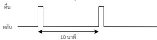
รูปที่ 56 โหมดการทำงานของโหนดเซนเซอร์ที่จะตื่นทุก ๆ 10 นาที
