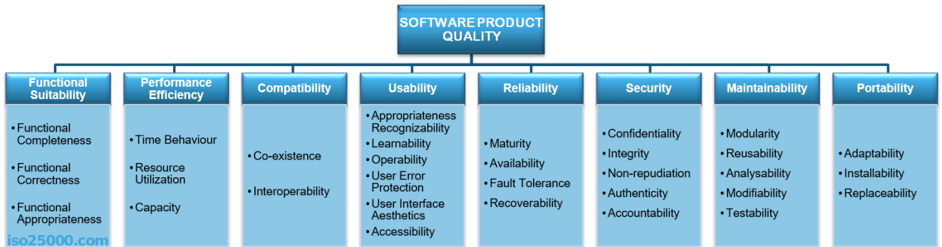
ภาพที่ ๔-๑๙ การประเมินคุณภาพระบบ ตามเกณฑ์คุณลักษณะทั้ง ๘ ด้าน ที่มา : คณะผู้วิจัย
