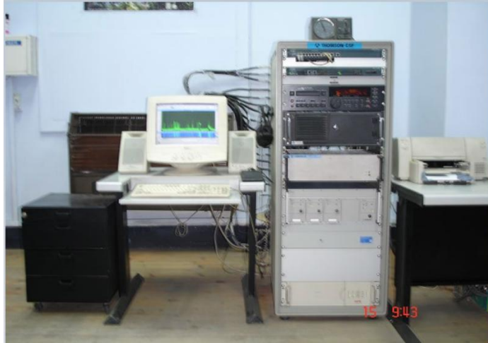
รูปที่ 67 ตัวอย่างสถานีตรวจสอบคลื่นความถี่แบบประจำที่ (ITU Academy – 2020)
