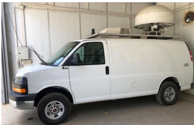
รูปที่ 68 ตัวอย่างสถานีตรวจสอบคลื่นความถี่แบบเคลื่อนที่ (ITU Academy – 2020)
